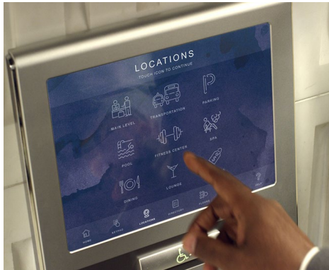
Modelo de pantallas táctiles con botón de accesibilidad, Ej. Modelo Otis Compass
