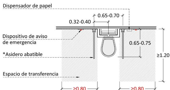
Se recomienda que la cisterna sea de tanque bajo para garantizar una superficie de apoyo cómoda para la espalda y una altura accesible del mecanismo de descarga, además de la separación adecuada del inodoro de la pared para facilitar la transferencia.
