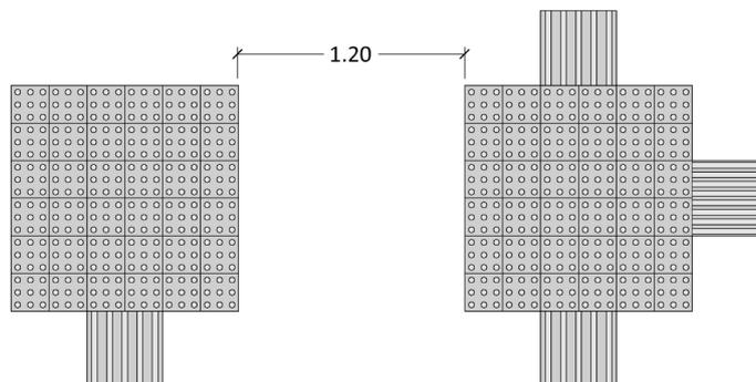
Excepcionalmente, para evitar la aproximación excesiva entre pavimentos tacto-visuales debida a la falta de espacio, una de las dimensiones podrá reducirse hasta el mínimo de **0,80 m**.
